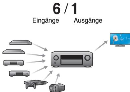
Dieses Gerät verfügt über 6 HDMI-Eingänge und 1 HDMI-Ausgänge, die Verbindungen mit verschiedenen HDMI-kompatiblen Geräten wie Blu-ray Disc-Playern, Spielekonsolen und HD-Videokameras ermöglichen.
