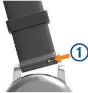
2 Setzen Sie eine Seite des Federstegs für das neue Band in das Gerät ein.
