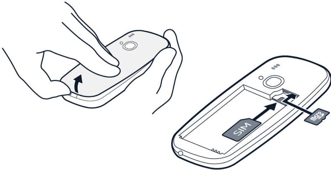
1. Setzen Sie Ihren Fingernagel in den kleinen Schlitz auf der Unterseite des Telefons und hebeln Sie das Cover ab.
