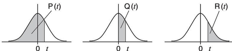
**▶t:** Diese Funktion, der das Argument  $X$  vorausgeht, bestimmt die normalisierte Zufallsvariable  $X \blacktriangleright t = \frac{X - \bar{x}}{\sigma_x}$ .
