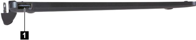
**1** USB-Anschluss Bietet Anschluss für USB-Geräte.
