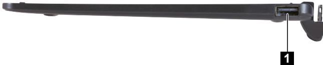
**1** USB-Anschluss Bietet Anschluss für USB-Geräte.
