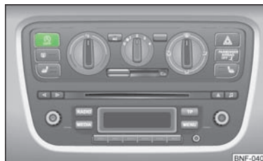
Abb. 67 Taste für das START-STOPP-System
