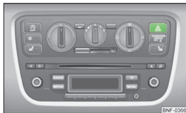
Abb. 23 Schalttafel: Schalter für Warnblinkanlage
