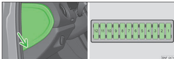
Abb. 119 Auf der Fahrerseite in der Schalttafel: Abdeckung des Sicherungskastens / Schematische Darstellung des Sicherungskastens
