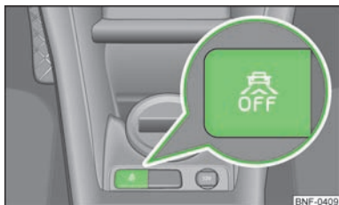
Abb. 69 Unterer Teil der Mittelkonsole: Taste für das City Safe Drive-System
