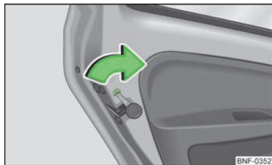
Abb. 9 Kindersicherung an den hinteren Türen
