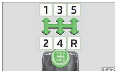
Abb. 63 Schaltschema des 5-Gang-Schaltgetriebes
